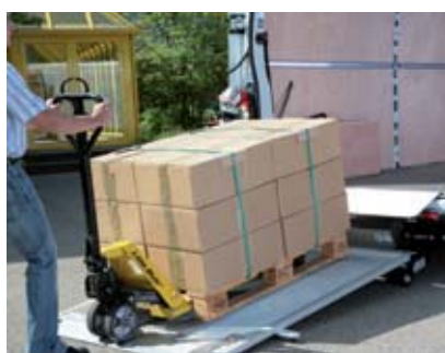
Dostatek místa pro europaletu a paletový vozík. Velmi plochý nájezdový úhel (6,2°).
