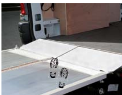
Dělený můstek VanBridge spojuje podlahu ložné plochy s plošinou. Protiskuzová úprava TracGrip a SideGrip.
