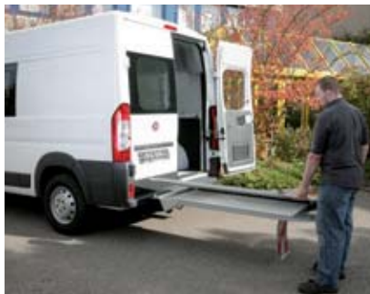
Hydraulické otvírání a ruční rozkládání.
