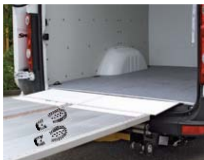
VanBridge spojuje podlahu ložné plochy vozidla s plošinou. Výškový rozdíl u standardní podlahy 12 mm.
