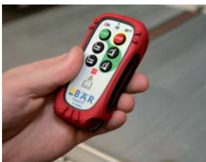
Dálkové bezkabelové ovládání s bezpečnostní funkcí.
