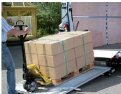
Dostatek místa pro europaletu a paletový vozík. Velmi plochý nájezdový úhel (7,7°).
