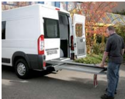
Hydraulické otvírání a ruční rozkládání.
