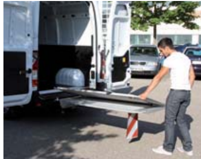
Hydraulické otvírání a ruční rozkládání.
