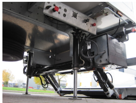
OAH013.60.LE - Hydr. stabilising leg straight 4T LE ... mm
