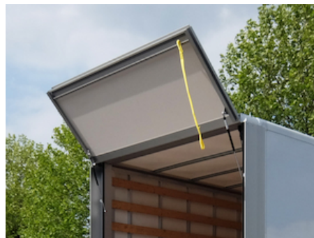
OVF064 - Top hatch DH-VOCS 135°
