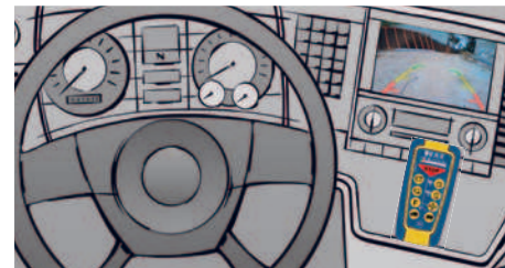
Bär SmartControl pro ovládání z kabiny (zvláštní výbava) – ovládání Cargoliftu z kabiny řidiče ve spojení s Bär SmartControl Plus s dokovací stanicí. Viz oddíl Technologie.
