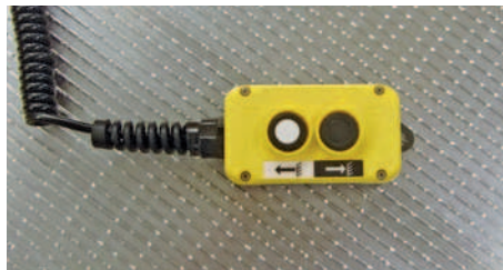
Dálkové ovládání na kabelu (zvláštní výbava) se dvěma funkcemi zdvíhání a spouštění. Zásuvka pro kabel může být umístěna u hlavní ovládací jednotky, nebo v nástavbě. Pozice pro obsluhujícího je na plošině viditelně označena.
